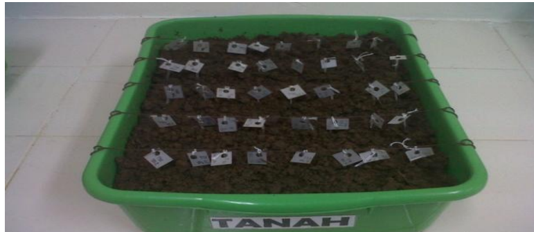
Gambar 2. Proses pengujian biodegradasi film plastik campuran PS dan P(3HB) dalam media tanah
